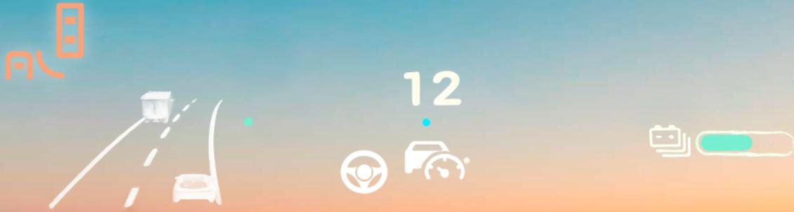
\* Tecnología que proyecta información relevante sobre el vehículo en el parabrisas o en un panel debajo de la línea de visión del conductor. Esto permite que el conductor pueda ver la información sin apartar la vista de la carretera.
